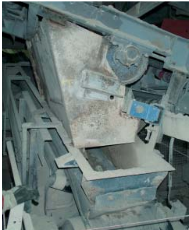
Перегрузочный бункер – налипание материала
